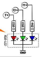
Bei RGB-LEDs ist meistens das längste Anschlussbein der gemeinsame Minuspol. Welcher der anderen Anschlüsse für welche Farbe zuständig ist, probierst du am besten (mit einem 220  $\Omega$  Schutzwiderstand) aus.
