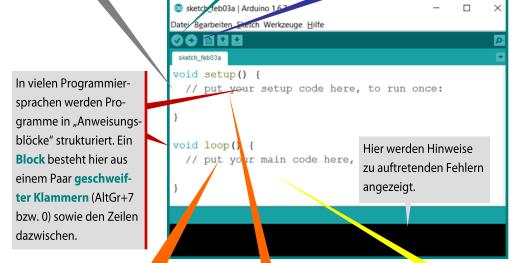
Zwei Anweisungsblöcke sind vorgeschrieben: Die Anweisungen im Block **setup()**{...} werden direkt ausgeführt, sobald man den Arduino startet. Danach werden die Anweisungen im Block **loop()**{...} ausgeführt und immer wieder wiederholt...Das nennt man auch "Endlosschleife".
