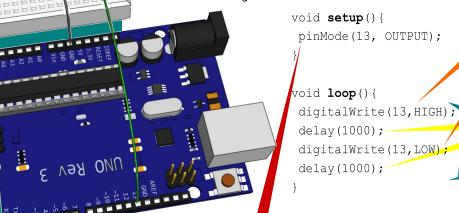
Damit die Leuchtdiode blinkt, wird Pin 13 hier "HIGH" und wieder "LOW" geschaltet.
