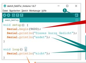
Mit dieser Zeile wird die Verbindung zum Computer hergestellt - man sollte das in einem Programm nur ein Mal machen. Die angegebene sogenannte Baudrate von 9600 wird in der Marginalspalte erklärt.
